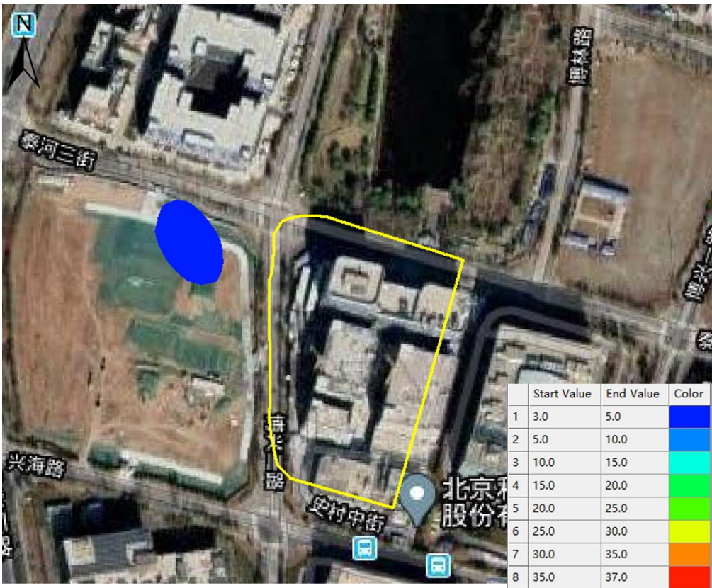
图 6.3-11 调节池废水停止泄漏后 1095 天 COD 水平迁移扩散（浓度：mg/L）
