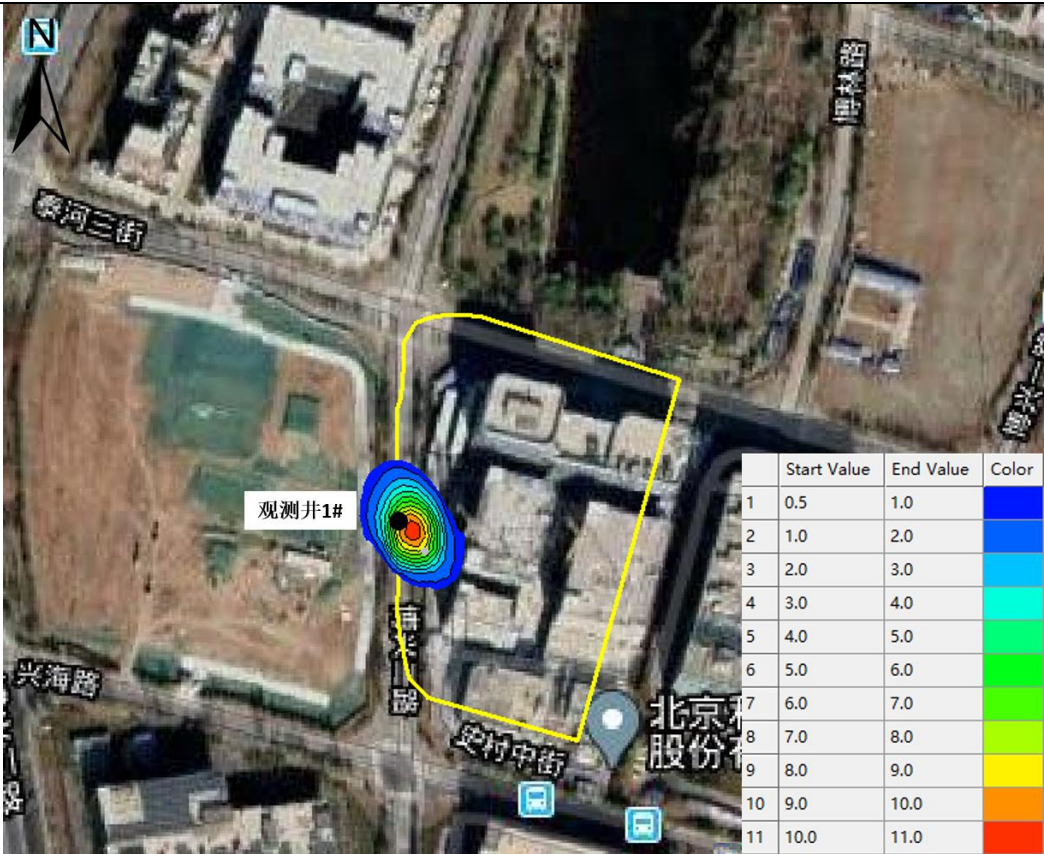
图 6.3-16 调节池废水停止泄漏后 100 天氨氮水平迁移扩散（浓度：mg/L）
