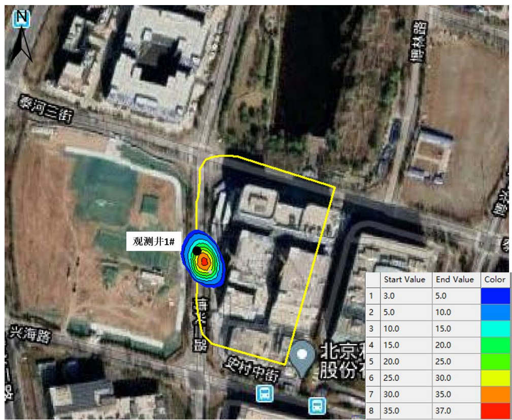
图 6.3-9 调节池废水停止泄漏后 100 天 COD 水平迁移扩散（浓度：mg/L）
